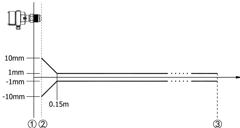
① 测量基准面 ② 仪器天线末端 ③ 测量量程范围
